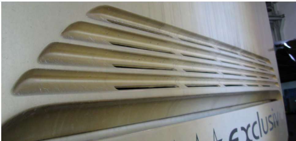
✓ Leichte Dellen und Oberflächenkratzer am Heckbereich
