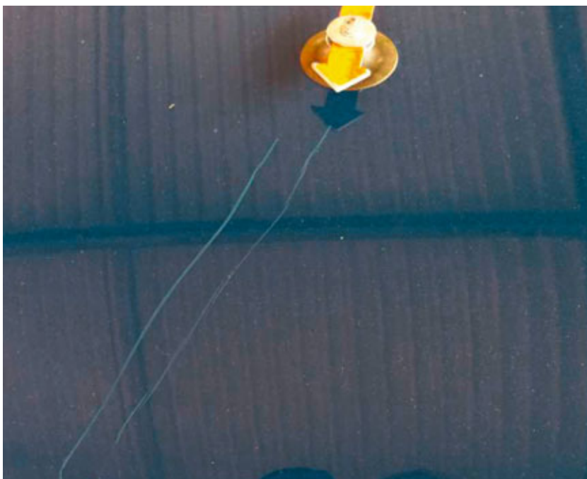
Beschädigung des Basislacks
