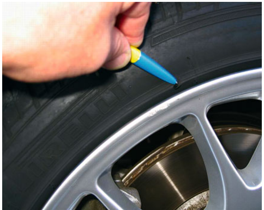
Leichte Materialabtragung an der Scheuerleiste
