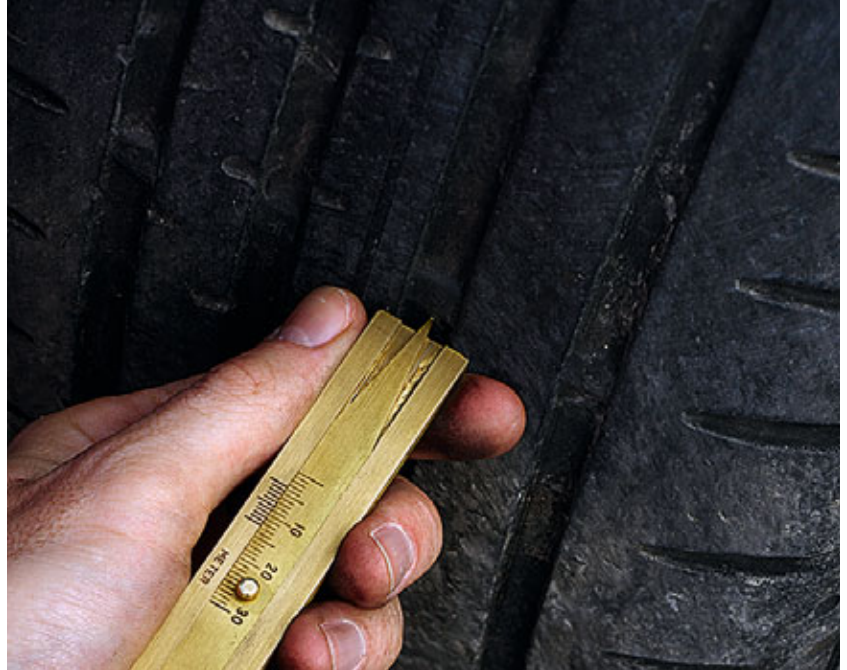
Profiltiefe Sommerreifen > 2 mm
