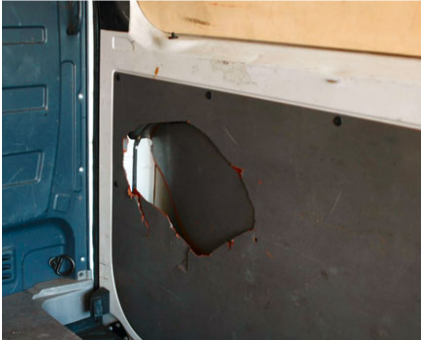
Bruch der Verkleidung
