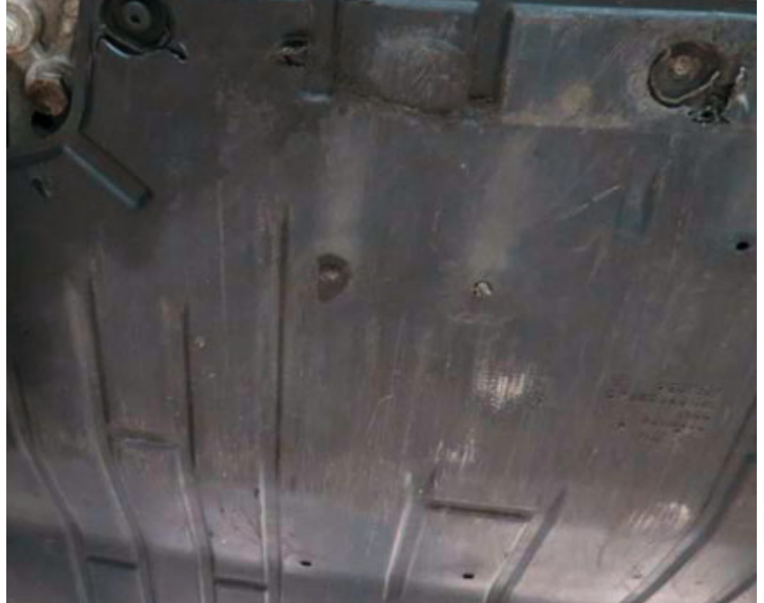
Leichte Kratzer an der Unterbodenverkleidung
