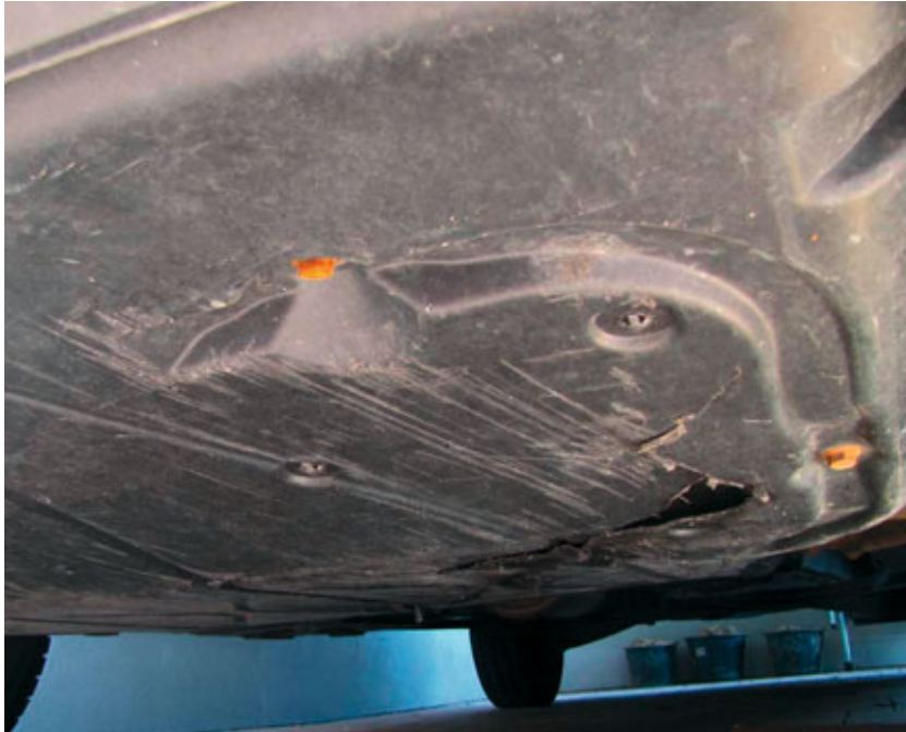
Beschädigung der Unterbodenverkleidung
