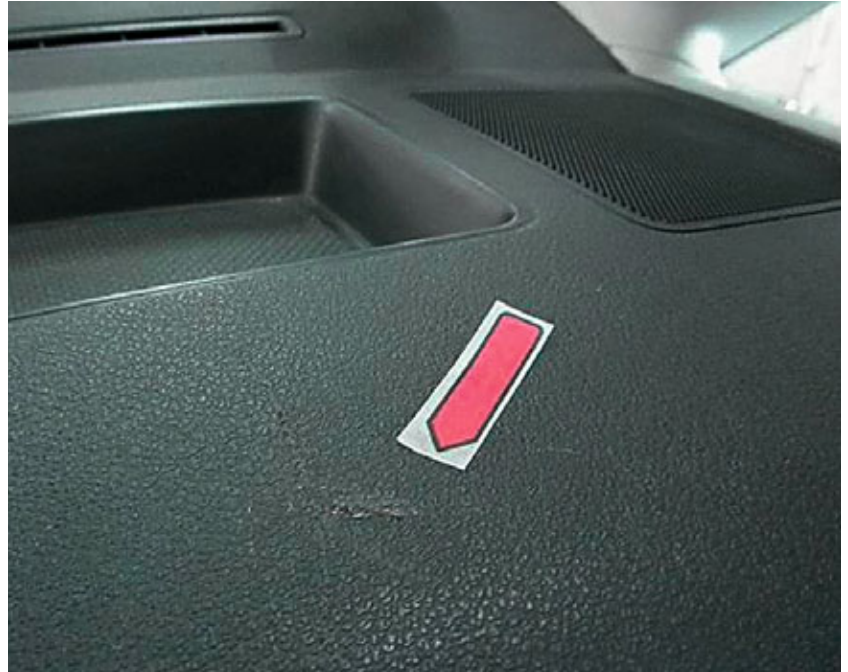
Leichter Kratzer am Armaturenbrett
