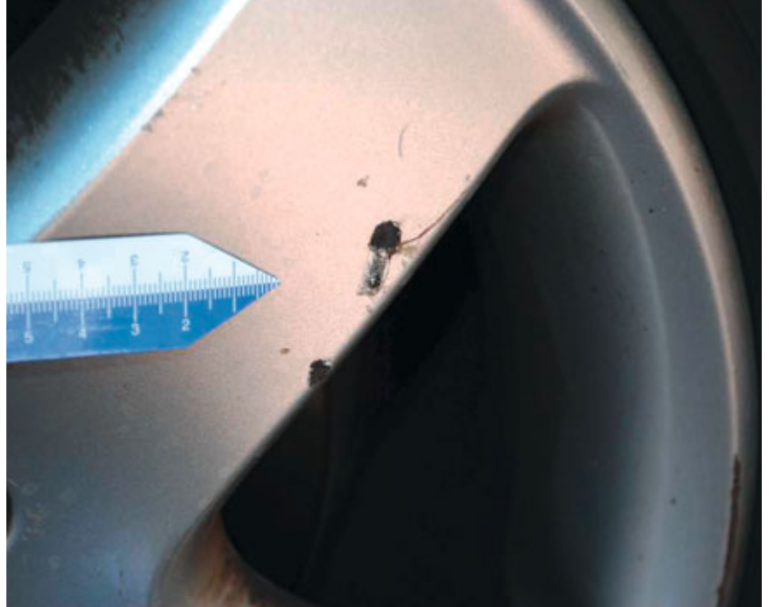
Leichte Kratzer ohne Materialabtragung
