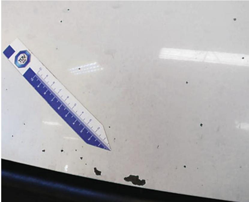
Mehr als fünf Steinschläge pro 10 × 10 cm
