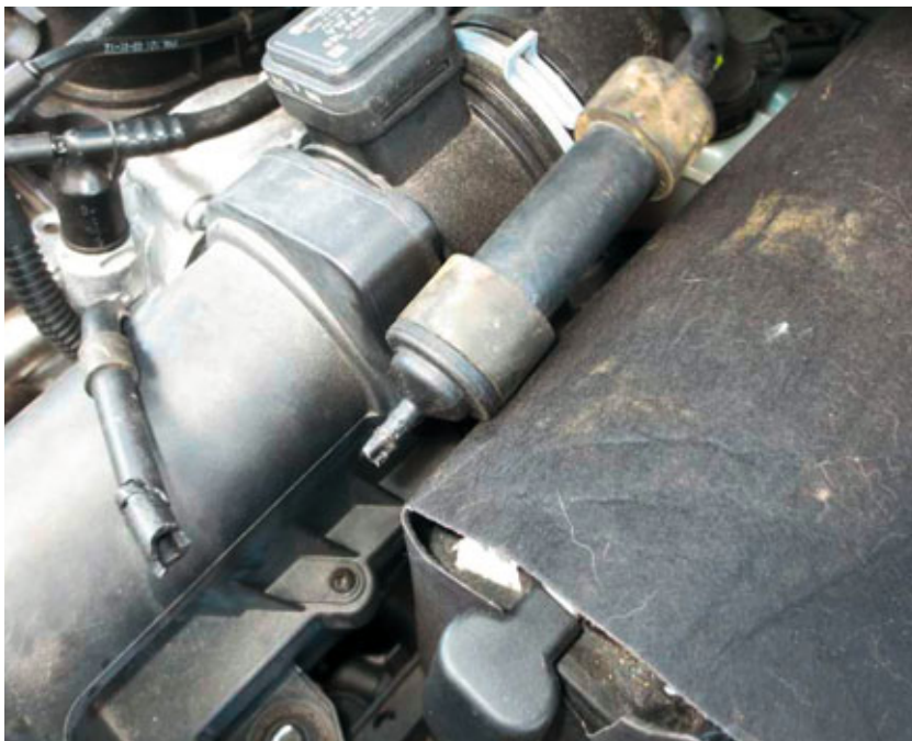
Beschädigung durch Nagetiere
